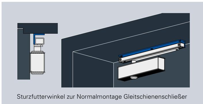
Sturzfutterwinkel zur Normalmontage Gleitschienenschließer
